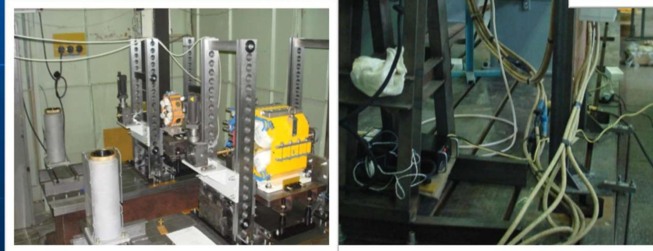
Определение положения скакки, каретки с датчиками Холла относительно геодезических знаков на элементе.
